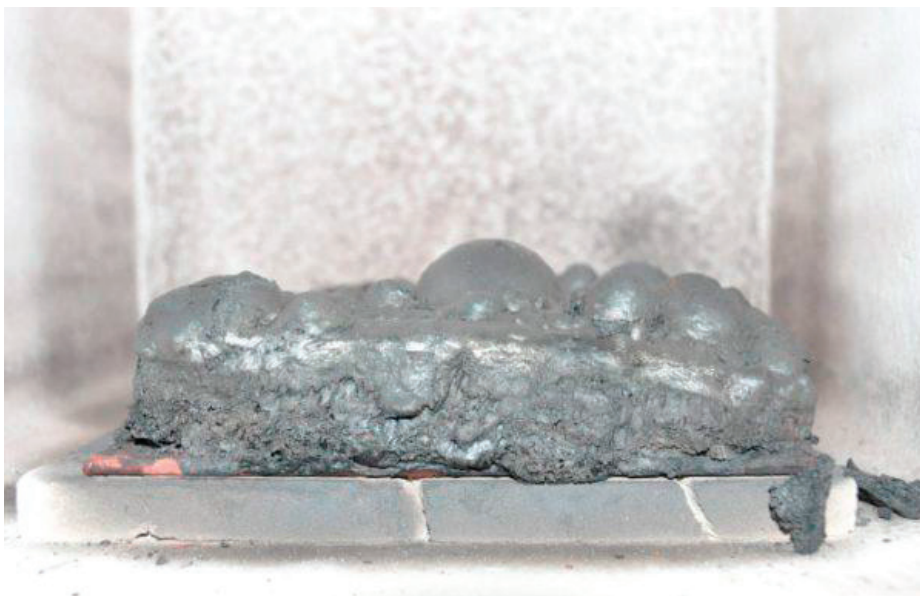
Рис. 2. Пример вспучивание огнезащитной краски
