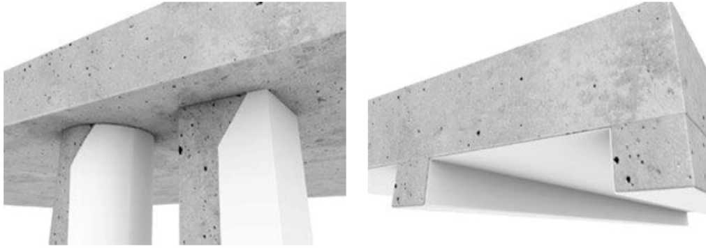
Рис. 1. Пример нанесения огнезащитной краски на колонны и балки
