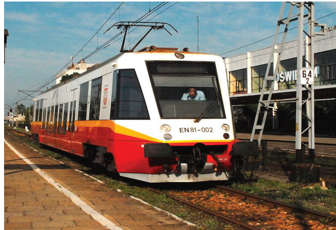
Рис. 2. Электрический пассажирский вагон постоянного тока 3 кВ серии EN81, используемый для полевых испытаний с установленной крышей
