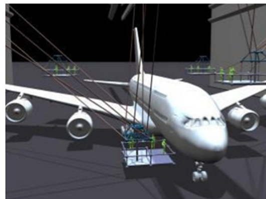
Рис. 5. CableCrane — конструкция на базе двухбалочного мостового крана [5]
