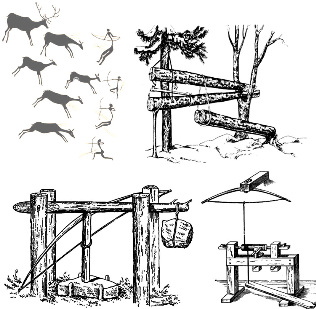
Рис. 1. Первое применение гибких связей: петроглифы Беломорья — сцена охоты с луками; охотничье самодельное орудие для сдавливания пушного зверя; сверлильный снаряд (реконструкция [2]); лучковый токарный станок [2]
