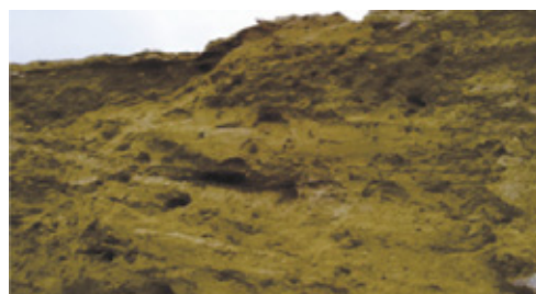
Рис. 1. Песчано-гравийная смесь бурого цвета с включениями гальки, валунов, отсортированная, имеются прослой гравийно-галечных отложений (первый слой)
