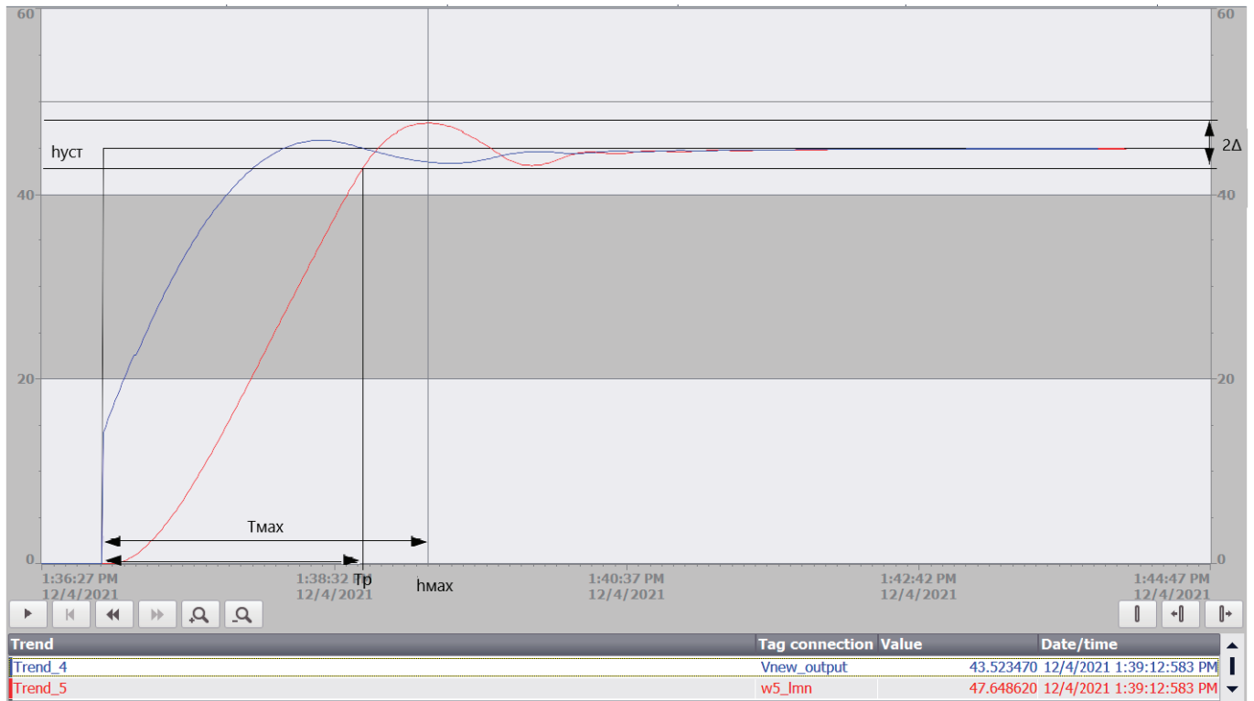
Рис. 13. Переходной процесс системы с PID-регуляторами
