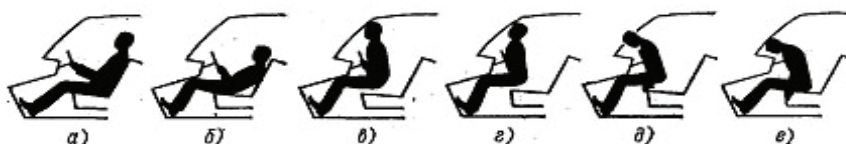
Рис. 5. Механизм образования травм у водителя при столкновении автомобилей
