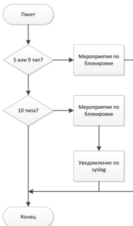
Рис. 9. Алгоритм обнаружения аномалий протокола ICMP
