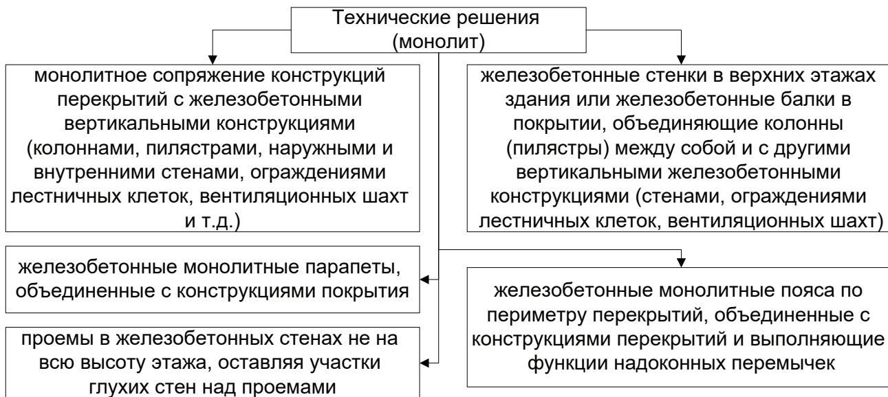
Рис. 2. Возможные технические решения для повышения устойчивости монолитных ЖБЗ к ПО (по данным [6])
