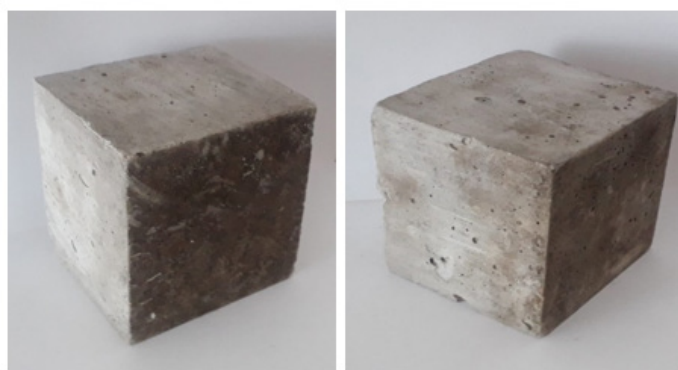
Сурет 2. Цемент пен цемент, кальций хлориді бар күл негізіндегі толтырғыштарды қолдану арқылы алынған жеңіл бетондардың үлгілері: а — цемент қосылған күл толтырғышы бар бетон текшесі, б — цемент, кальций хлориді қосылған күл толтырғышы бар бетон текшесі
