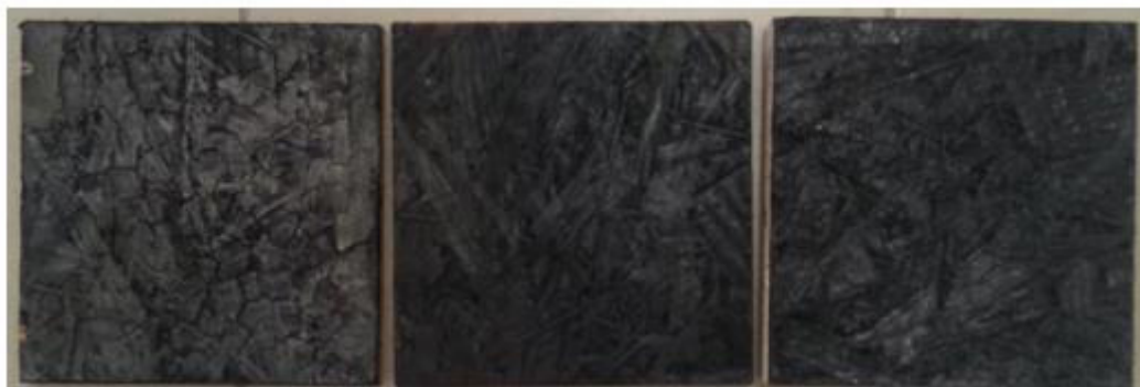
Рис. 7. Образцы ОСБ при воздействии теплового потока 44 \text{ кВт.м}^2 на 10 минут. (слева: 8 мм, 14 мм, 25 мм)
