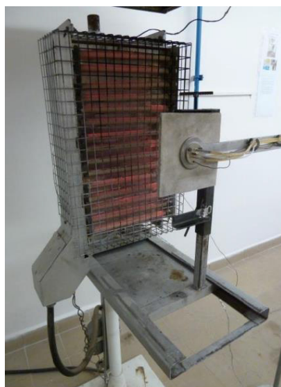
Рис. 2. Вертикальная панель электрического излучения с радиометром
