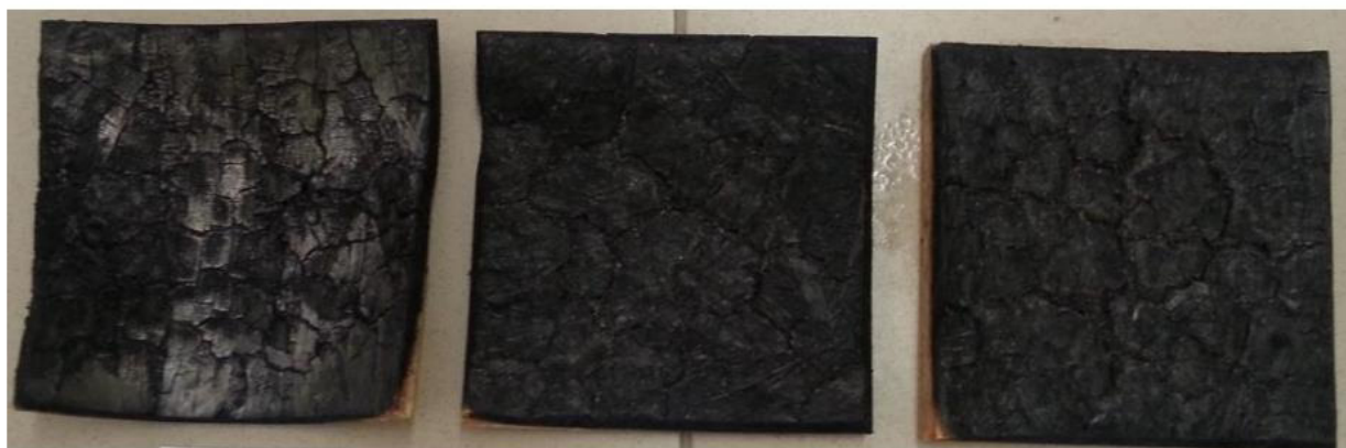
Рис. 5. Образцы OSB подвергается воздействию теплового потока от 31 \text{ кВт} \cdot \text{м}^{-2} на 10 минут. (слева толщина образца: 8 мм, 14 мм, 25 мм)
