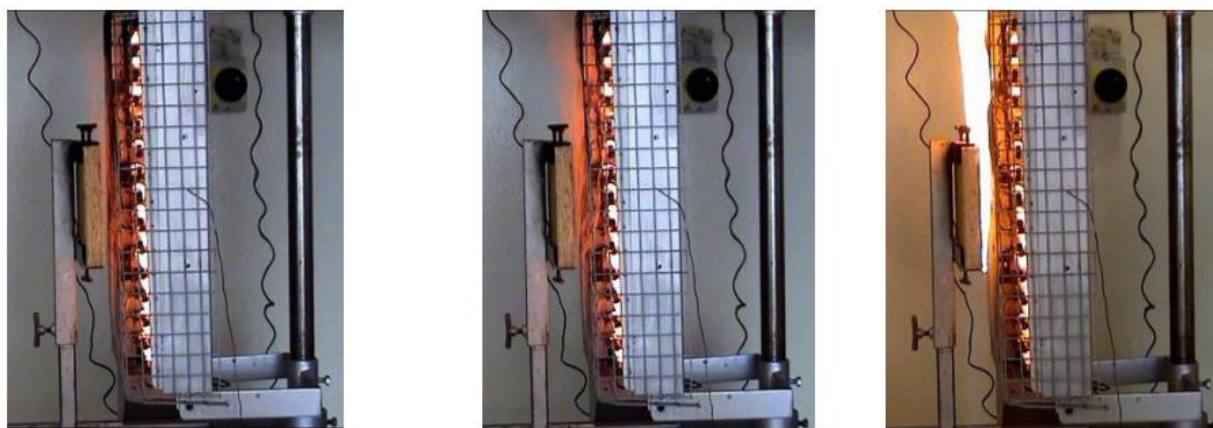
Рис. 8. Эксперимент по воспламеняемости плиты OSB толщиной 25 мм при тепловом потоке 53 \text{ кВт.м}^{-2}
