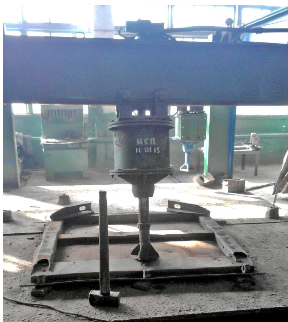
1 расм. Ярм очиқ вагон барча эшик ва қопқоқли туйнуклари учун пресслаш ускунасининг умумий кўриниши
