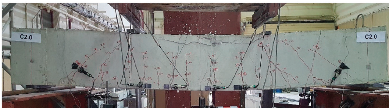
Рис. 4. Балка C2.0 при натурном испытании
