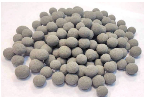
Сур. 1. Күл негізінде жасалған жеңіл толтырғыш үлгілері: а) күйдіруге дейін; б) күйдергеннен кейін.
