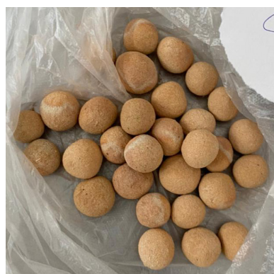
Сур. 1. Күл негізінде жасалған жеңіл толтырғыш үлгілері: а) күйдіруге дейін; б) күйдергеннен кейін.
