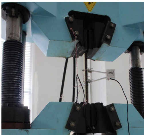
Рис. 1. Общий вид испытаний арматурной стали
