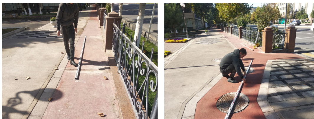
3-расм. Велосипед йўлаги бўйлама профилини нивелир ва рейка ёрдамида ўлчаш жараёни
