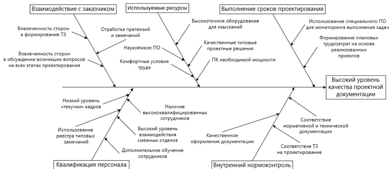
Рис. 1. Анализ факторов, влияющих на качество проектной документации, с помощью причинно-следственной диаграммы Исикавы
