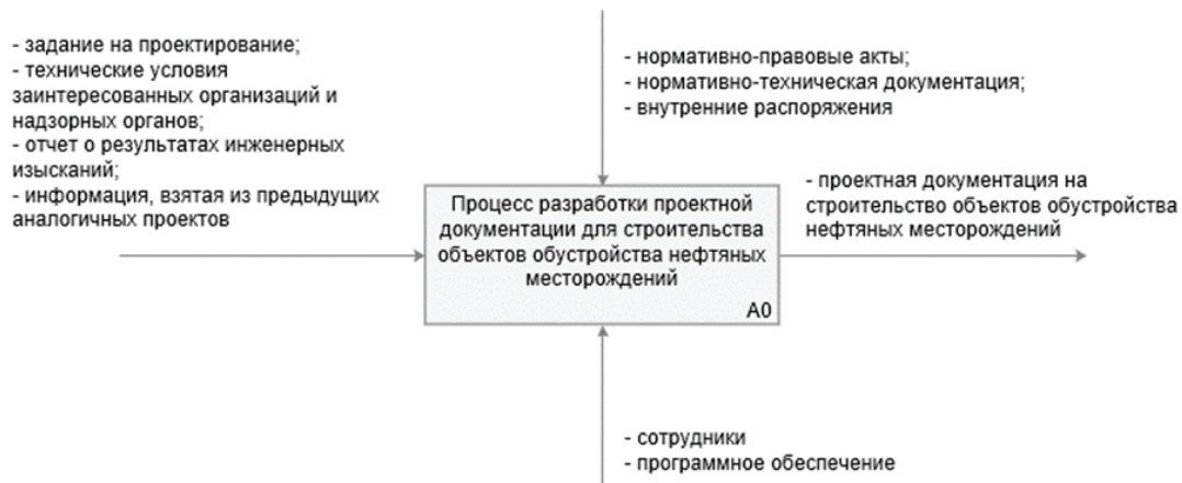
Рис. 2. Модель процесса разработки проектной документации для строительства объектов обустройства нефтяных месторождений в нотации IDEFO
