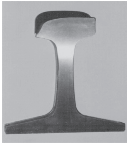
Рис. 1. Износ рельсов — высокий рельс на крутом повороте
