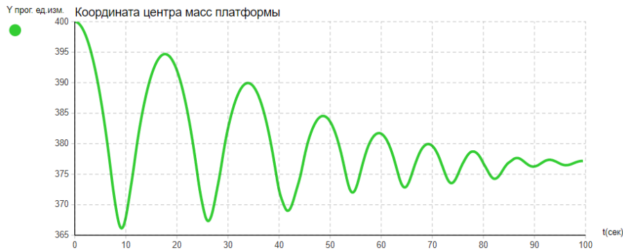
Рис. 8. Временной график координаты центра масс платформы
