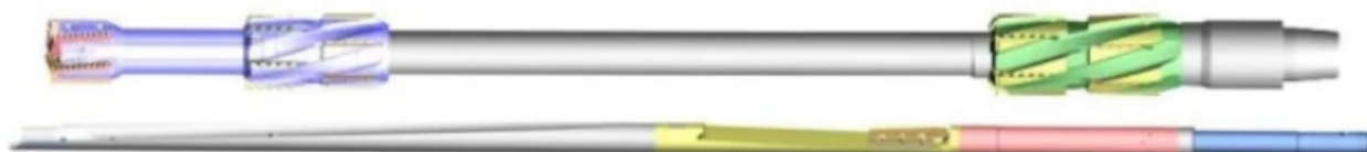
Рис. 2. Установка ориентированного уипстока в эксплуатационной колонне для бурения бокового ствола (нескольких стволов)
