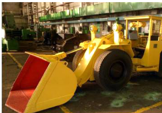
Рис. 8. Покраска внутренней стороны ковша и машины в разные цвета, в то время как заказчику разнообразие окраски не требуется
