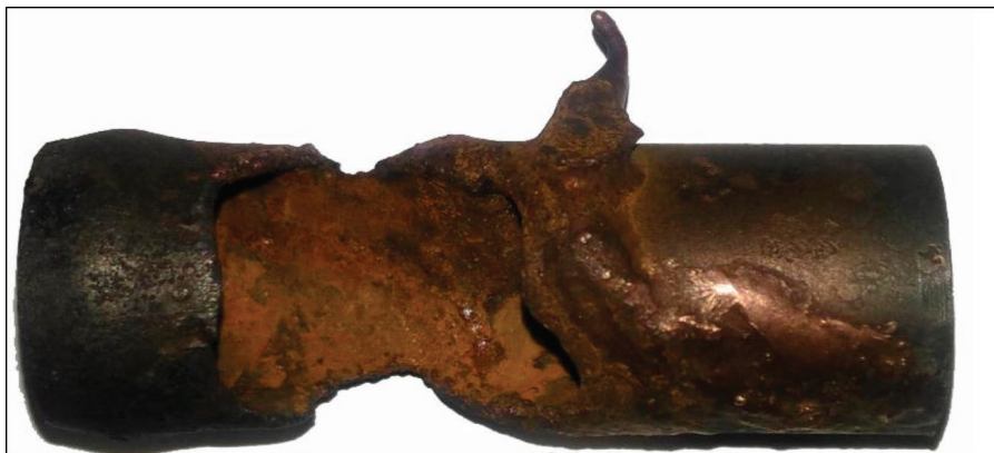
Рис. 2. Локальное проплавление стального патрубка сапуна двигателя свеклоуборочного комбайна
