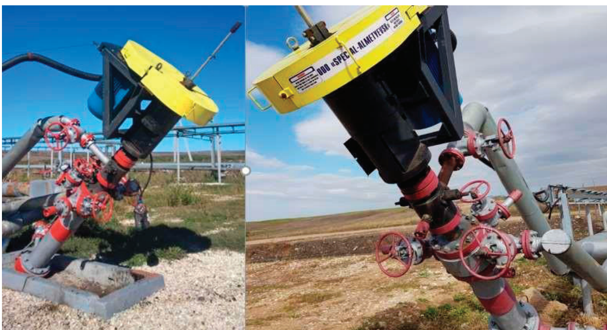
Рис. 1. Скважинное устье при добыче воды (во время использования УШВН)
