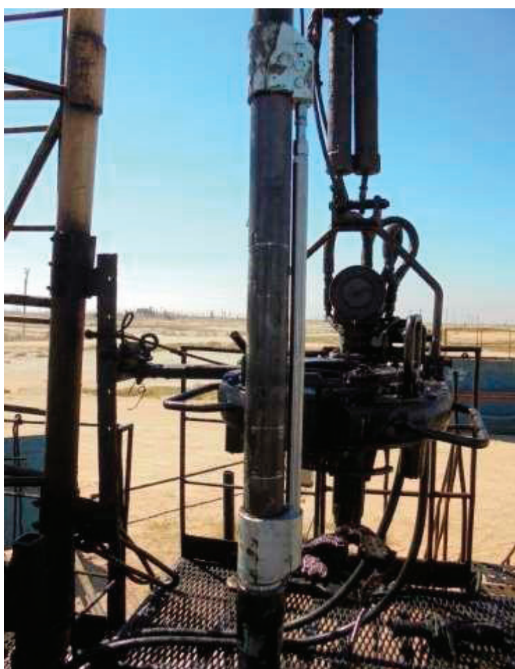
Рис. 3. Термоманометрическая система для УШВН
