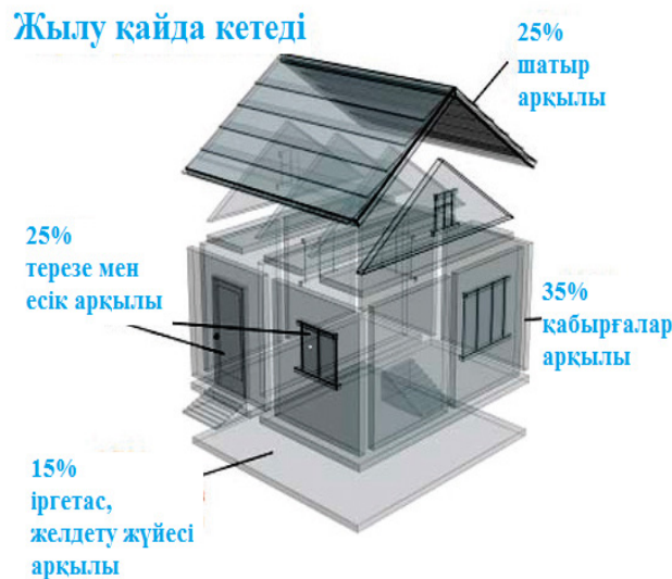
Сур. 1. Ғимараттың жеке элементтері арқылы жылу шығыны
