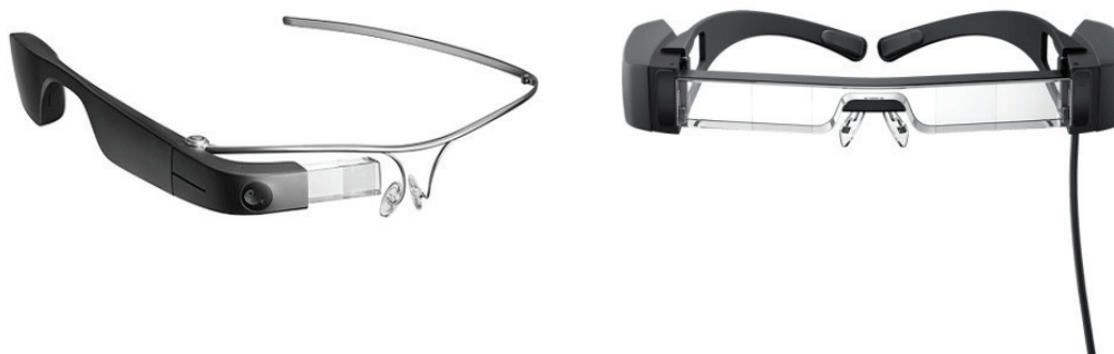
Рис. 5. GoogleGlass 2.0 EnterpriseEdition (слева) иEpsonMoverioBT-40 (справа) — одни из самых лёгких устройств дополненной реальности на сегодняшний вес. Масса каждого не превышает и 100 граммов
