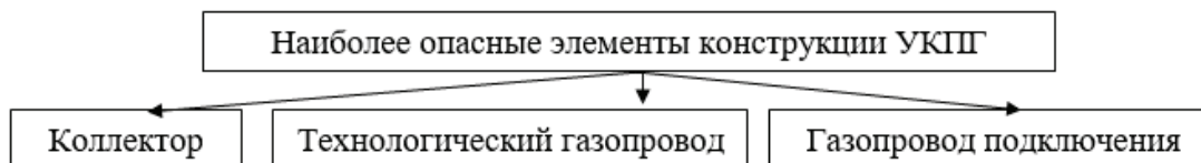
Рис. 6. Наиболее опасные элементы конструкции УКПГ
