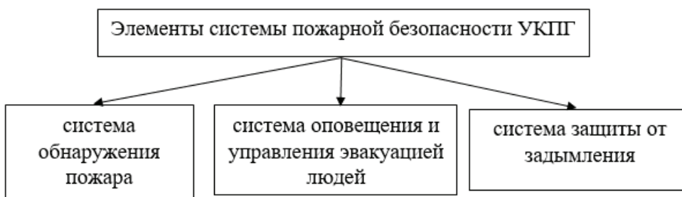
Рис. 4. Элементы пожарной безопасности УКПП
