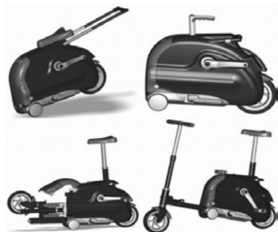
Рис. 3. Трансформация для эффективного транспортирования
