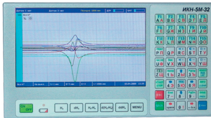
Рис. 1. Прибор для измерения концентрации напряжений ИКН-5М-32
