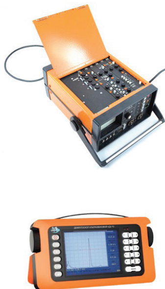
Рис. 3. Ультразвуковые дефектоскопы типа УД2-12, УД2-70
