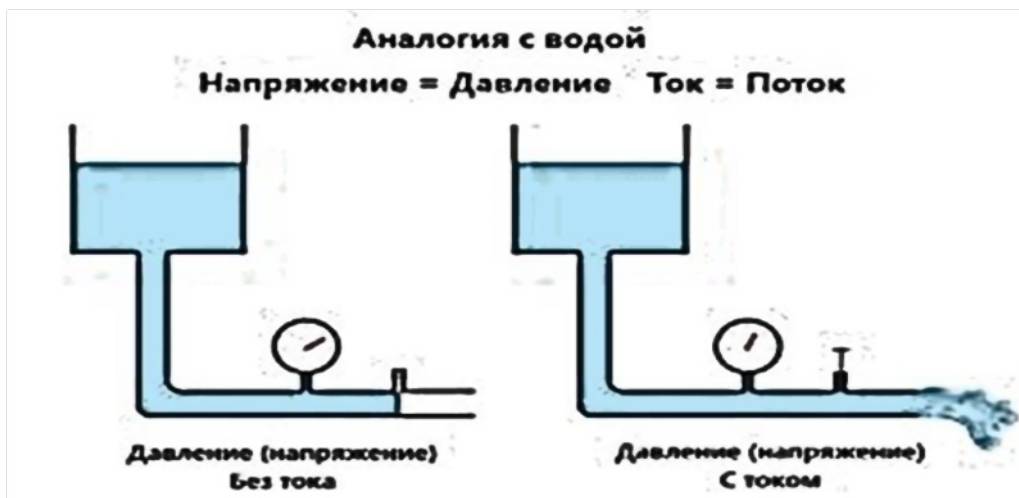
Рис. 2. Гидравлический аналог электрического тока для объяснения электрического напряжения и силы тока
