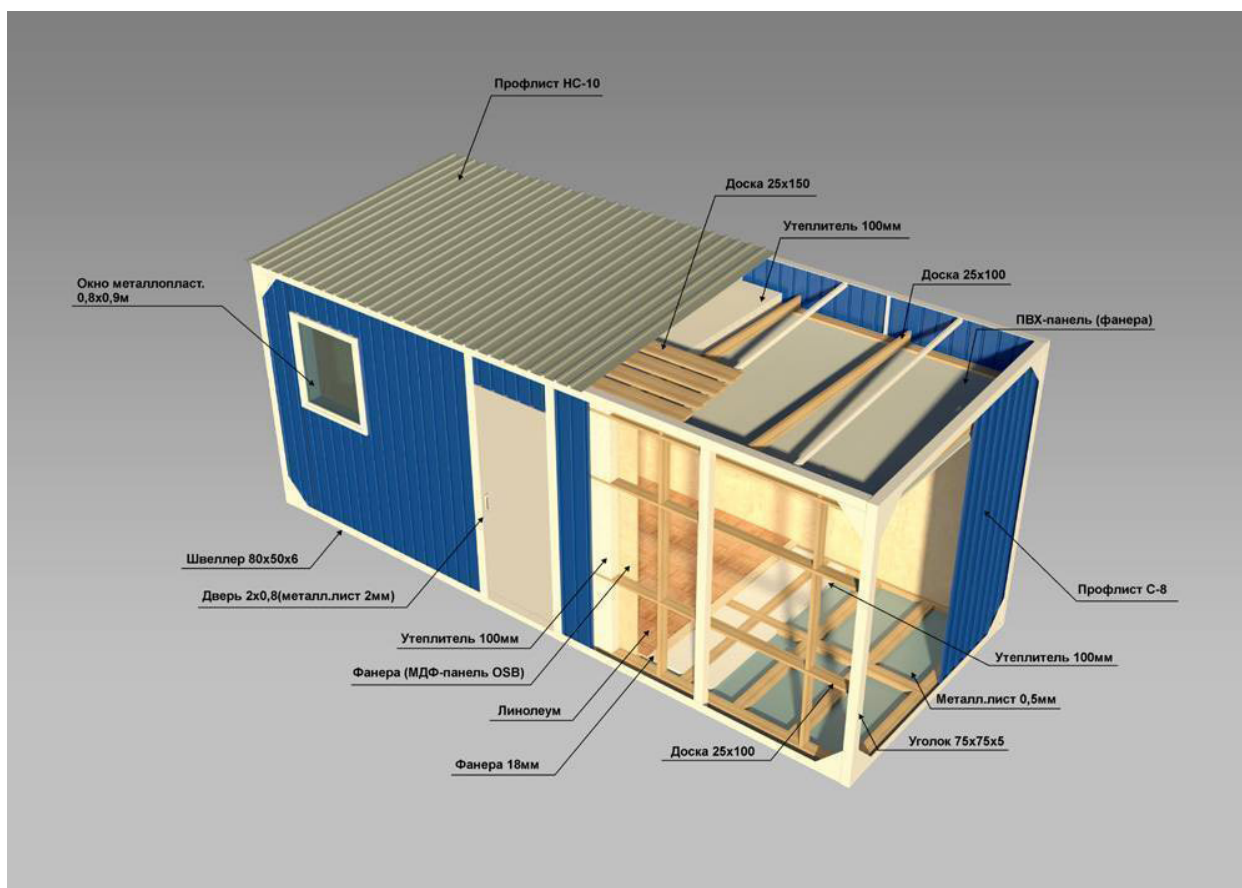
Рис. 1. Пример блок-модуля на стальном каркасе
