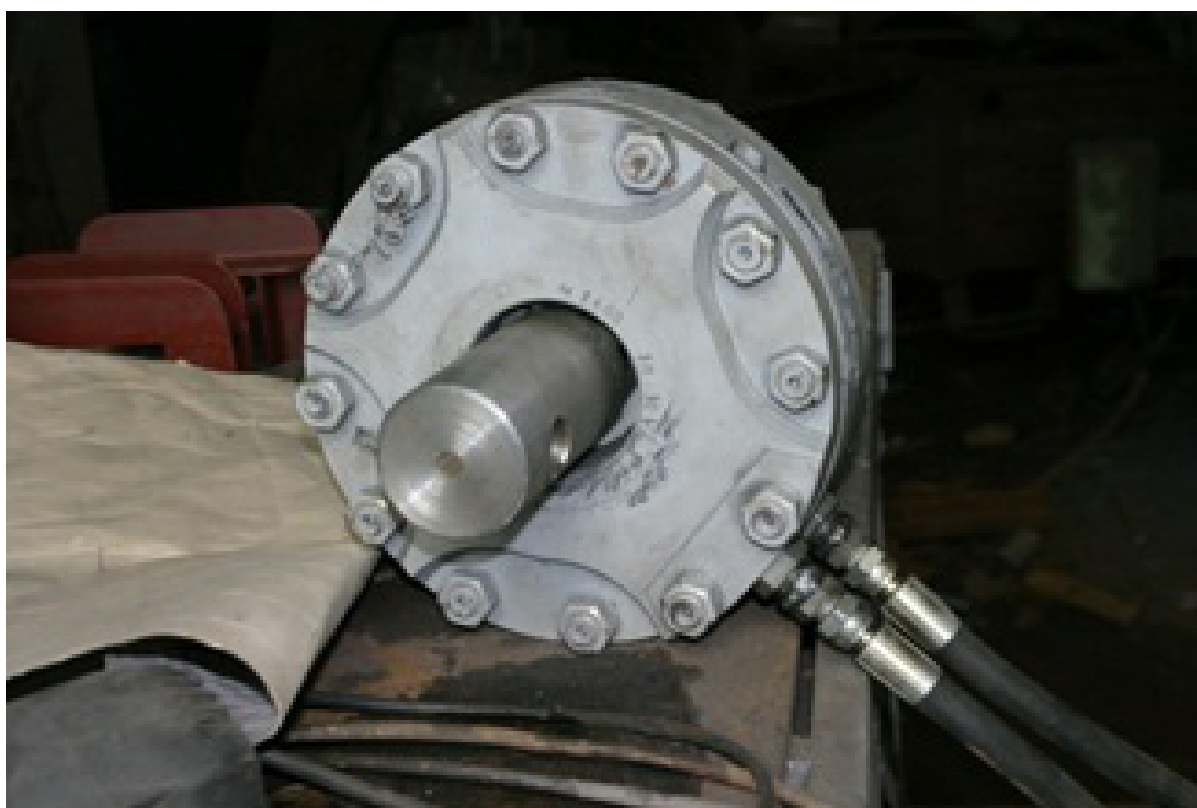
Рис. 1. Кабестан для ввинчивания винтовых свай в грунт
