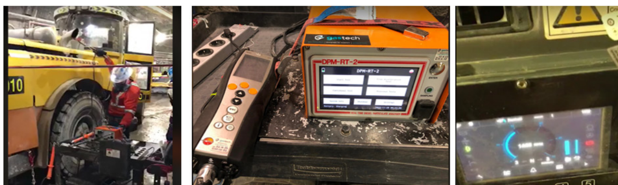
Рис. 1. Измерение выбросов токсичных отходов дизельными двигателями подземного рудника Оюу Толгой
