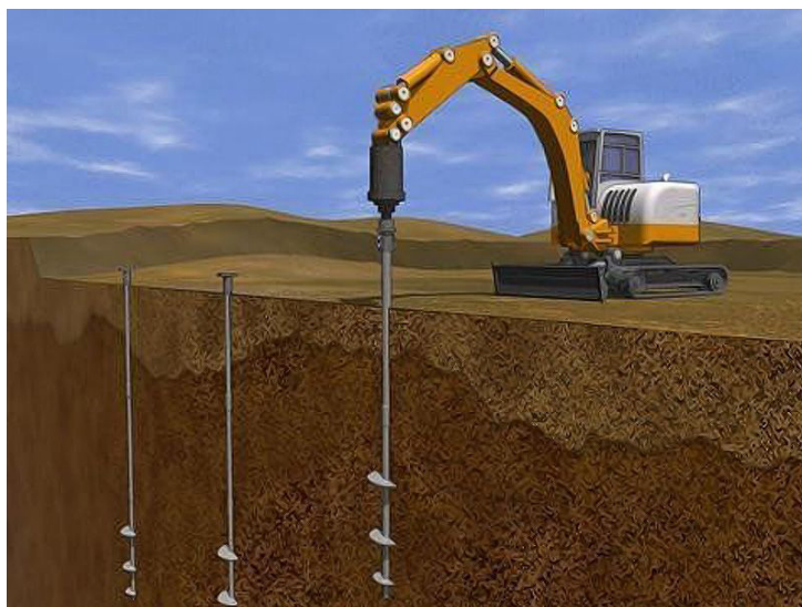
Рис. 2. Пример процесса заглубления винтовой сваи
