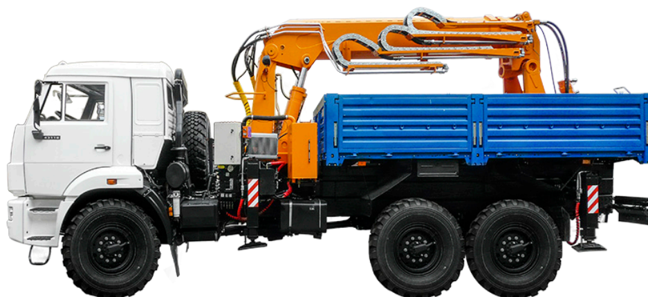
Рис. 3. Пример автотранспорта для погружения винтовых свай диаметром до 325 мм
