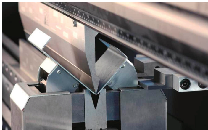
Рис. 1. Изготовление ТХП на кромкозагибочных прессах
