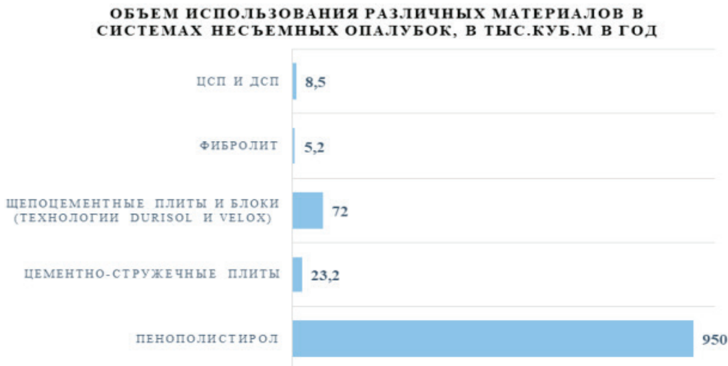
Рис. 1. График использования различных материалов в системах несъемных опалубок
