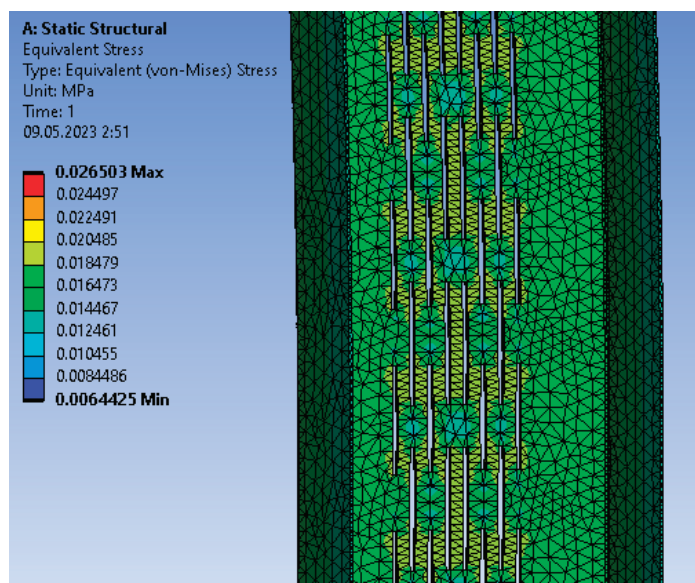
Рис. 6. Напряжения в стенке профиля
