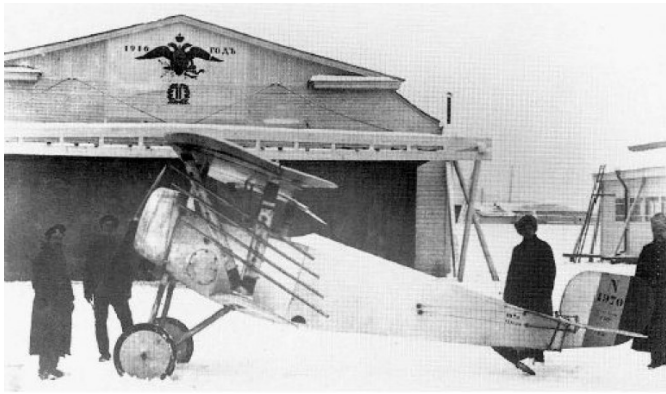
Рис. 5. Истребители Ньюпор-21 Гренадерского авиаотряда с установками для ракет Ле-Приера
