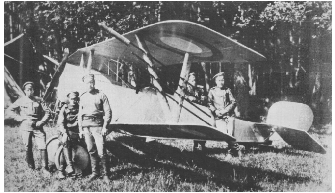
Рис. 5. Истребители Ньюпор-21 Гренадерского авиаотряда с установками для ракет Ле-Приера
