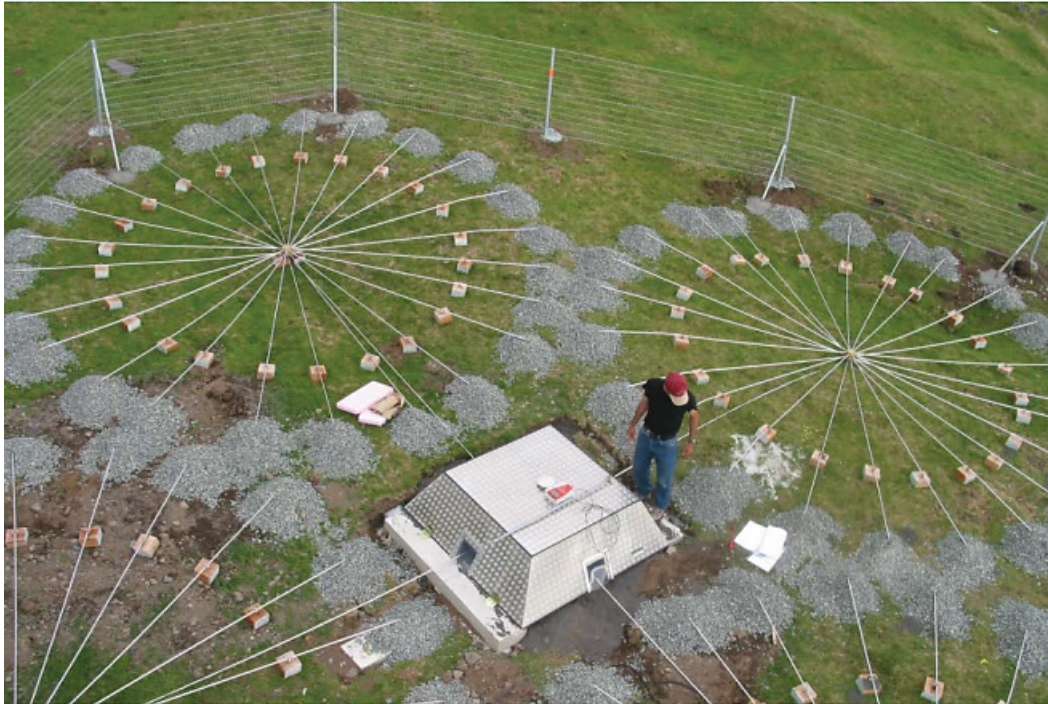
Рис. 3. Группы датчиков на инфразвуковой станции IS49, Тристан-да-кунья, Соединенное Королевство
