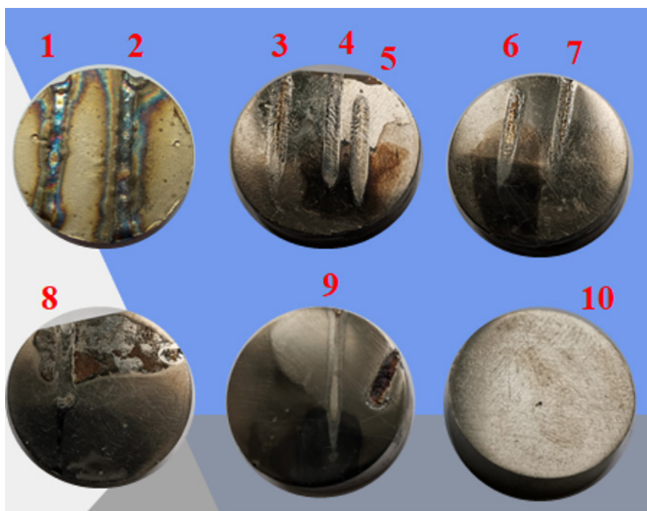
Рис. 1. Внешний вид образцов технического чистого титана VT1–0 после воздействия непрерывного лазерного излучения
