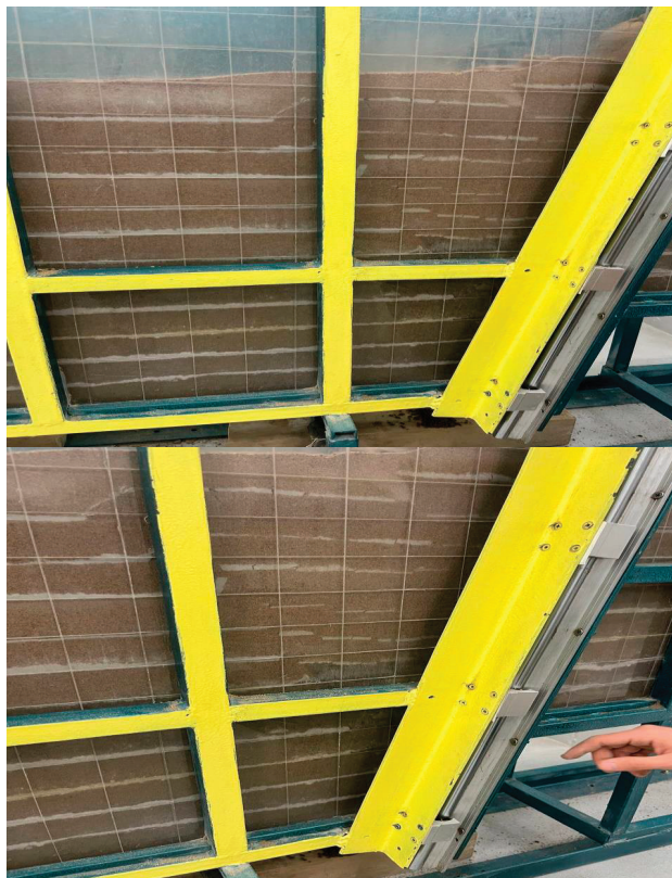
Рис. 9. Подробный вид перемещения слоев
