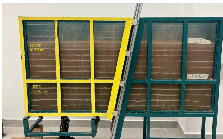
Рис. 6. Послойное заполнение конструкции
