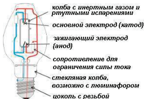
Рис. 1. Устройство газоразрядной лампы
