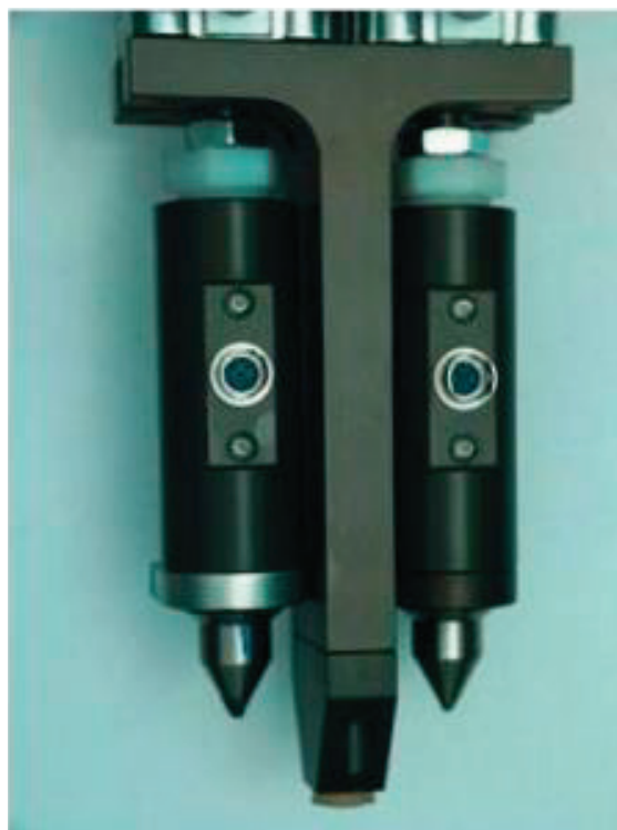
Рис. 2. Объединенный блок зондов для определения скорости распространения волн и проницаемости по газу
