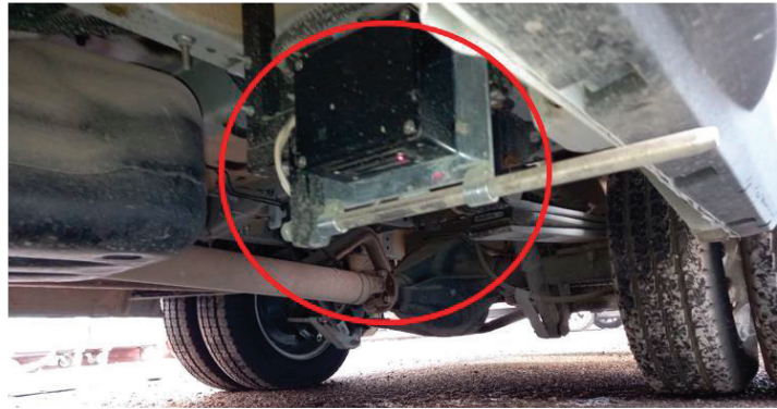
Рис. 2. Вид на лазерный профилометр, установленный в дорожной лаборатории «ТРАССА»
