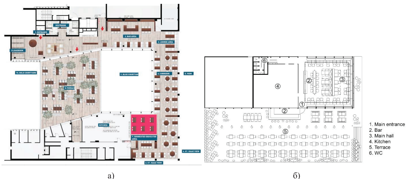
Рис. 1. Планы российских зданий общественного питания а) Ресторан «Мансарда» Санкт-Петербург, Россия, 1050 м 2 ; б) Кафе и пекарня «Булка» Парк Горького, Москва, Россия, 228 м 2
