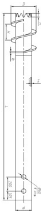
Рис. 2. Свая для вечномёрзлых грунтов
