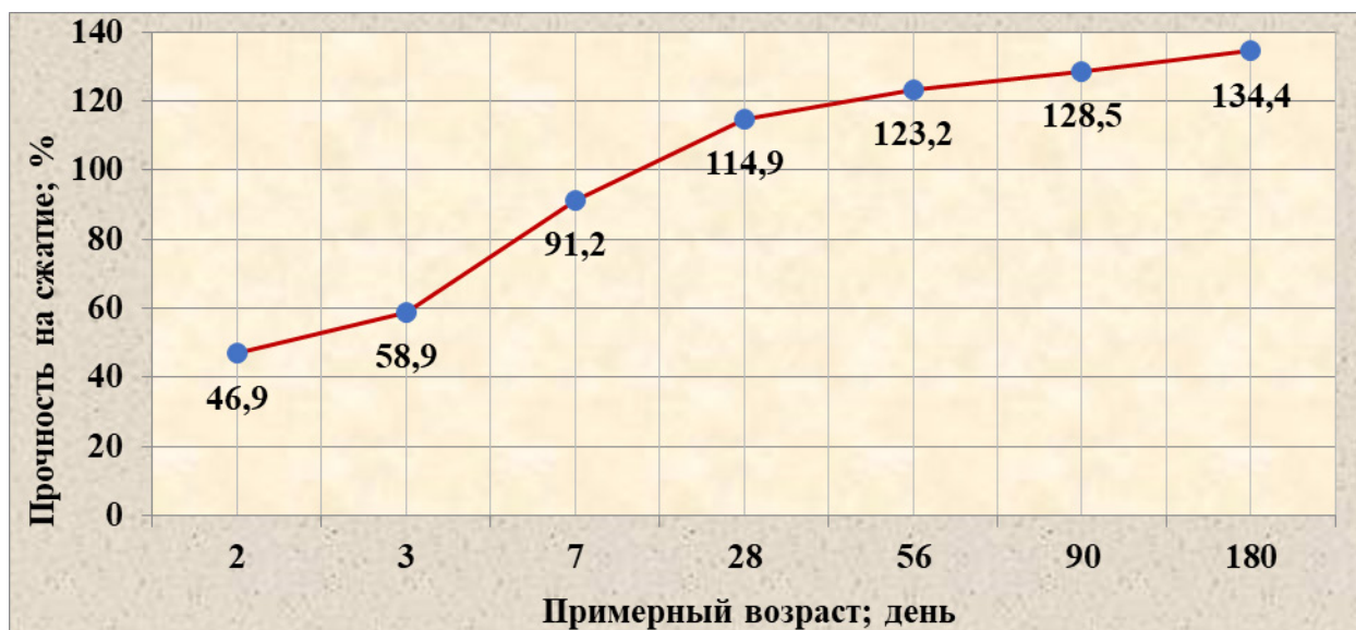
Рис. 1. График зависимости прочности цементобетона на сжатие от расчетного возраста
