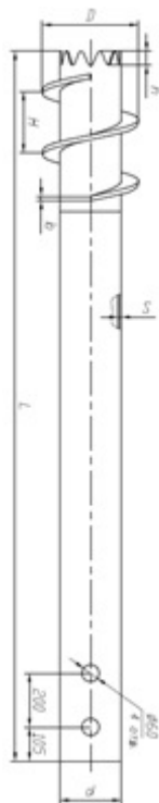
Рис. 2. Свая для вечномёрзлых грунтов
