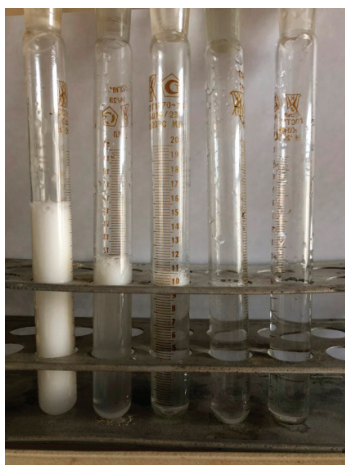
Рис. 1. Изображение водных растворов N-(додеканоилокси)этил-N, N-(диметил)аммонийпропионата в процессе пенообразования
