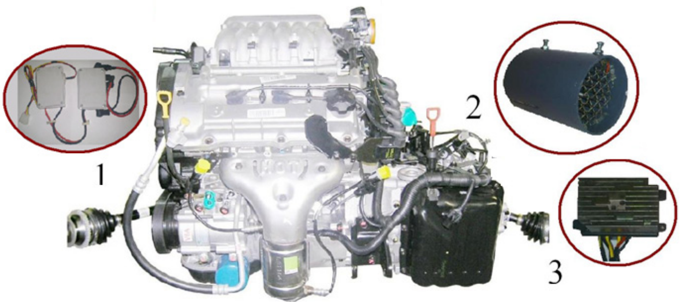
Рис. 4. Внешний вид системы озонирования воздуха: 1 – преобразователь напряжения; 2 – озонатор; 3 – электронный блок управления.
