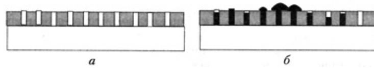
Рис.1. Схема технологического процесса изготовления наноструктур на поверхности проводящего материала электрохимическим осаждением через маску рог-AL2O3: а) исходная структура; б) осажденным в поры металлам
