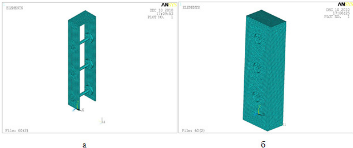
Рис. 3. Разбивка элемента на сетку МКЭ: а) металлической обоймы с болтами; б) деревянного элемента
