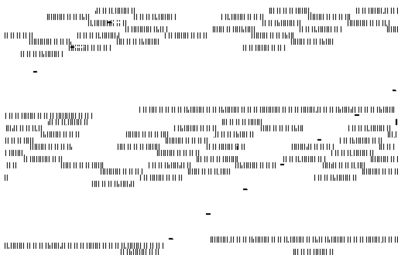
Рис. 4. Битовая карта принятого сигнала с помехами от пульта ИК ДУ
