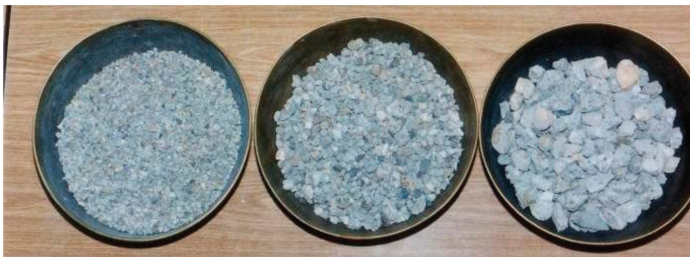
Рис. 1. Фракции заполнителя вторичного бетона. Слева направо 5–10 мм, 20–40 мм и 40–80 мм
