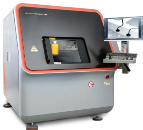
Рис. 2. Пример оборудования для рентген-контроля печатных плат
