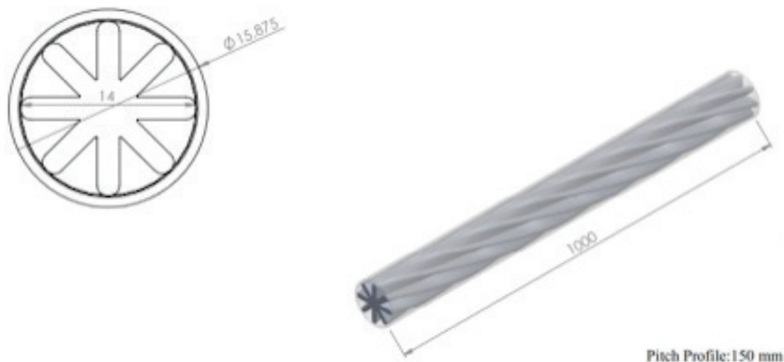
Рис. 3. Конфигурация винтового оребрения внутренней поверхности трубы [16]
