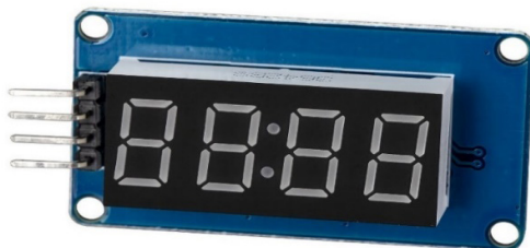
Рис. 5. Плата с контроллером TM1637 и индикатором 3642BS-1
