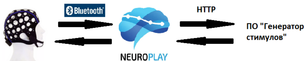
Рис. 1. Схема взаимодействия компонентов системы для исследования активности мозга
