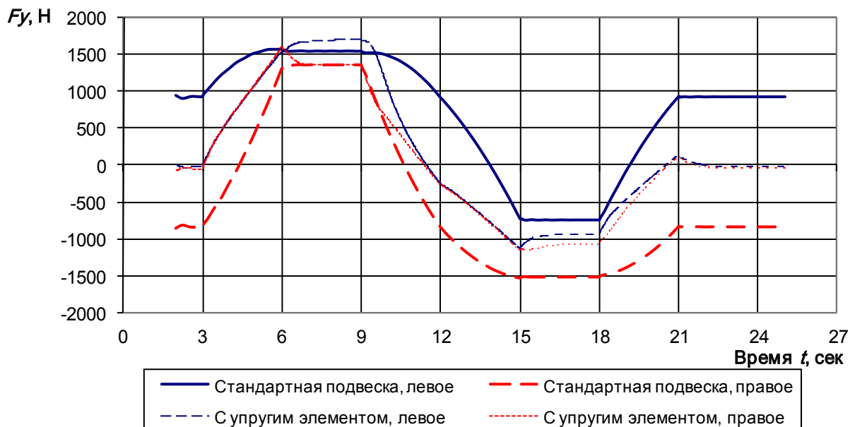
Рис. 7. Осциллограммы поперечных сил, действующих на управляющие колеса стандартной и измененной подвески при движении автомобиля по криволинейной траектории со скоростью 15 м/с
