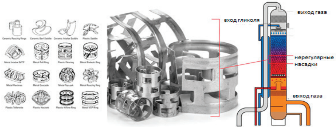
Рис. 4. Абсорбер с нерегулярными насадками [5]
