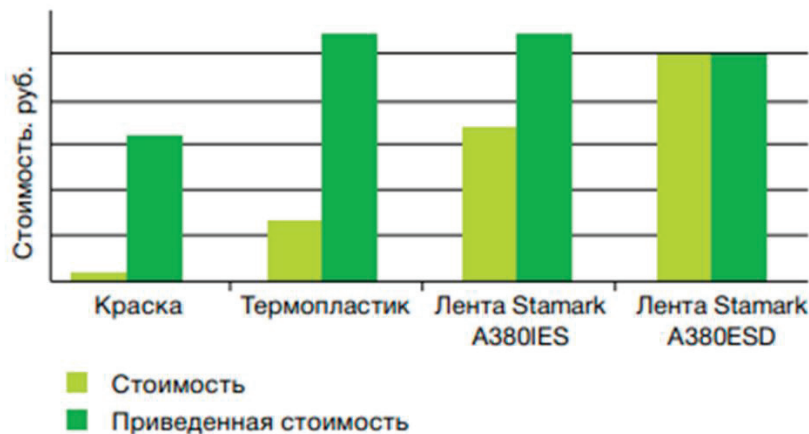
Рис. 5. Сравнение единовременной и приведенной стоимости материалов для дорожной разметки
