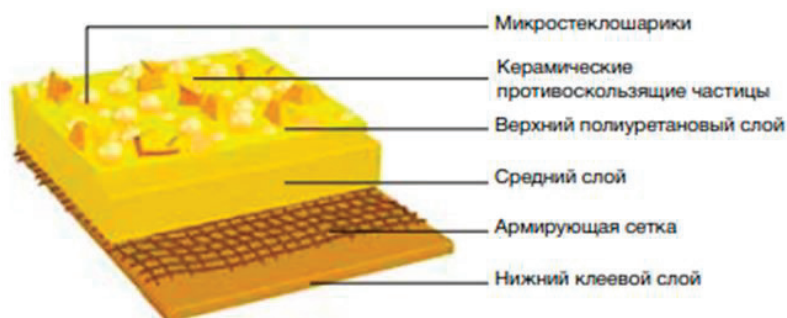
Рис. 3. Строение гладких лент
