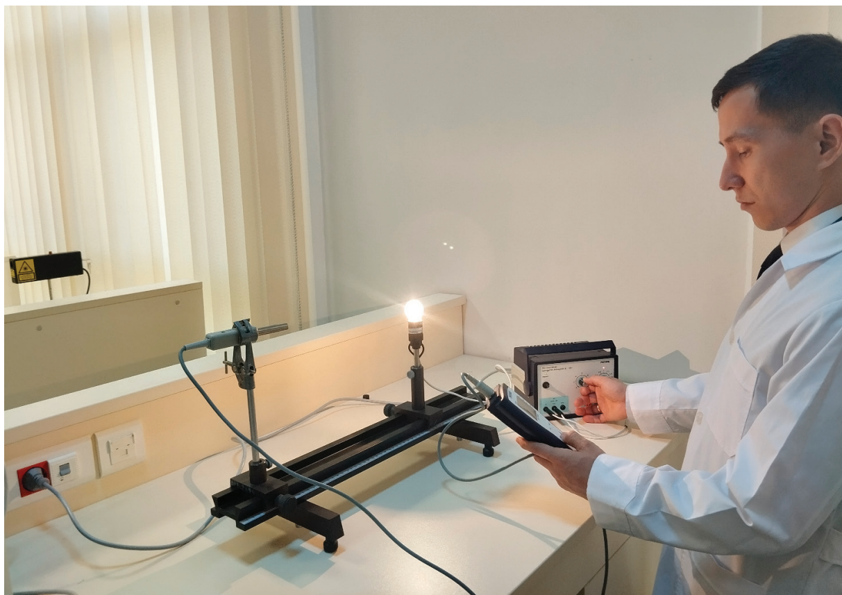
Рис. 1. Экспериментальная установка: Фотометрический закон расстояния
