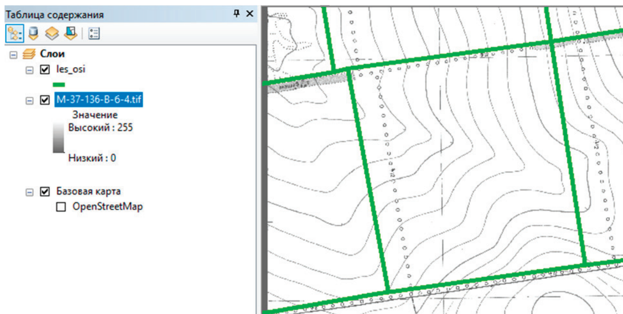
Рис. 4. Пример добавления в проект карты с отличающейся от настроенной в проекте системы координат
