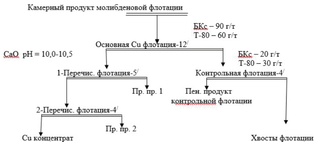
Рис. 2. Флотационная схема получения медного концентрата
